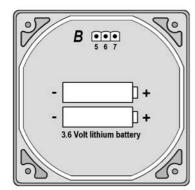
B Sensor SENSOR 5 GND 6 IN 7 V+
